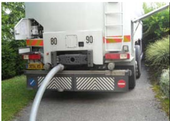
La livraison du granulé dans le silo de stockage se fait rapidement grâce à un camion souffleur.
